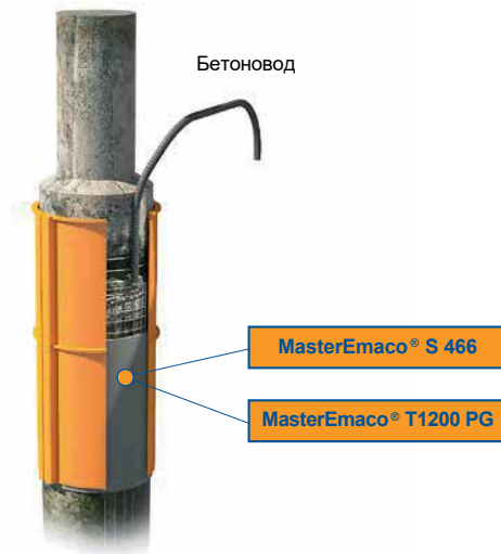
Ремонт с применением опалубки
