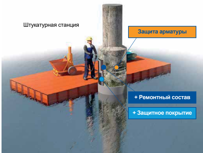
Ремонт надводной части
